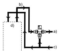
a) Mixed waterb) Hot waterc) Cold waterd) Boiler
