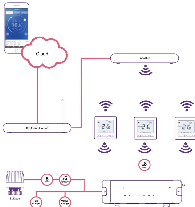
**HINWEIS:** Die Gesamtlast von 5A je Klemmleiste darf nicht überschritten werden, daher beträgt die maximale Anzahl von EMOtec, die mit der Schalteiste verbunden werden können, 12.
