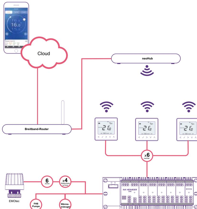
**HINWEIS:** Die Gesamtlast von 5A je Klemmleiste darf nicht überschritten werden, daher beträgt die maximale Anzahl von EMOtec, die mit der Schaltleiste verbunden werden können, 12.
