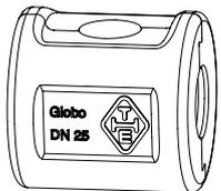
**Coquille isolante circuit chaud**
