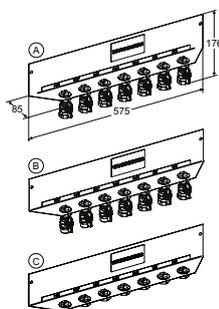
**Rail de raccordement avec 7 robinets boisseaux sphériques**
