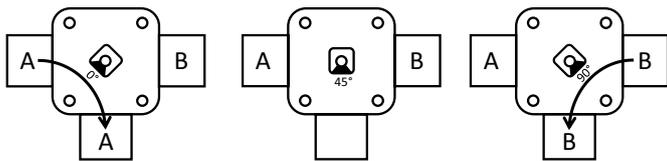
\*) Equilibrage des pressions: Un canal entre les ports 1 et 2 de 32° à 50°, permet d'assurer le maintien de pression de l'unité terminale à débit nul. **Important !** Les vannes de régulations doivent impérativement être connectées sur le port 3.
