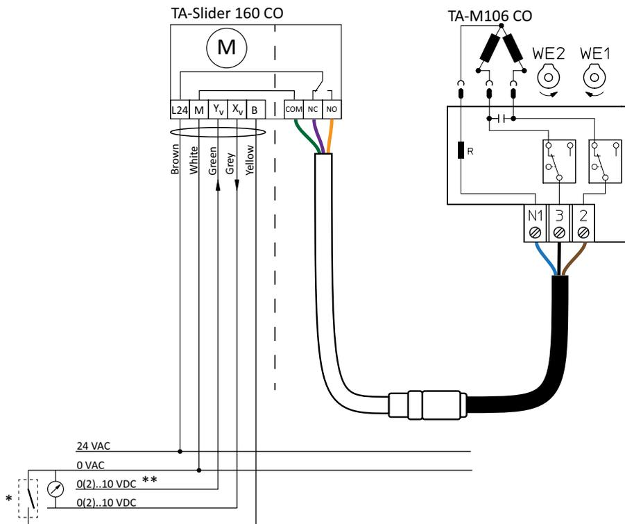
\*) L'entrée binaire peut être utilisée pour réaliser le basculement chaud/froid à la place du signal 0-10 V Dual-Range.
