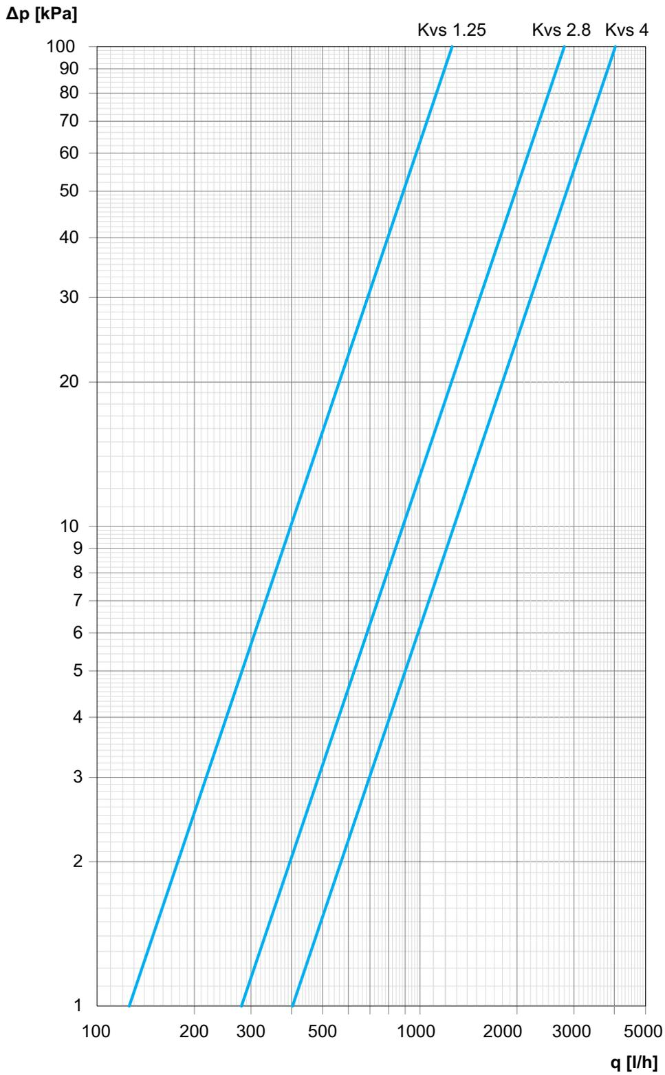
Kvs = Kv des deux vannes à boisseau sphérique complètement ouvertes (côtés A et B égaux)
