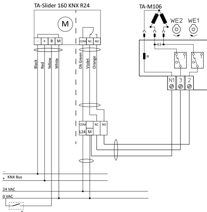
\*) le basculement chaud/froid peut être commandé via le bus KNX ou par l'entrée binaire.
