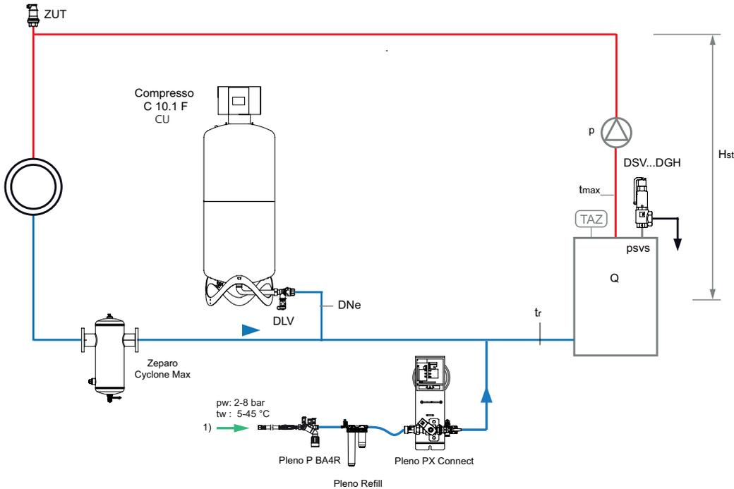
1) Raccordement eau de ville,  $p_w \geq p_0 + 1,7$  bar, (maxi. 8 bar)
