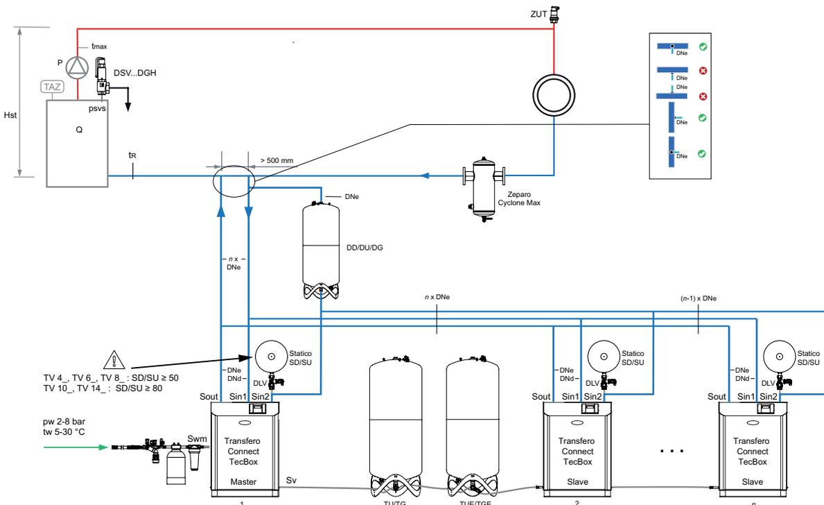
**Zeparo Cyclone Max** per la separazione centralizzata di fanghi e magnetite.
