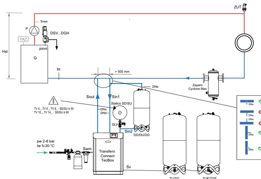
**Zeparo Cyclone Max** per la separazione centralizzata di fanghi e magnetite.
