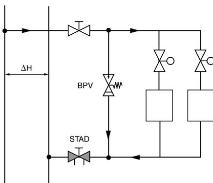
El cierre de las válvulas de dos vías de un circuito, provoca un incremento de la presión diferencial disponible debido a la reducción de las pérdidas de carga en tuberías. Este incremento debe ser soportado por las válvulas de control. Por ejemplo, en una instalación de calefacción presiones diferenciales de 3 m.c.a. (30 kPa) producen un funcionamiento ruidoso de las válvulas de radiador.
