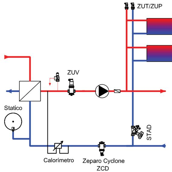
El separador de contaminantes Zeparo Cyclone debe ser montado aguas abajo del elemento que se quiere proteger o aguas arriba de la fuente de energía.
