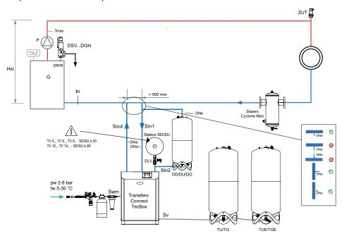
Zeparo Cyclone Max separador instalado como separador de lodos Zeparo ZUT purgadores de aire para salida y entrada de aire durante el llenado y vaciado Otros accesorios, productos y datos técnicos: Ficha de datos Pleno Connect, Zeparo y Accesorios
