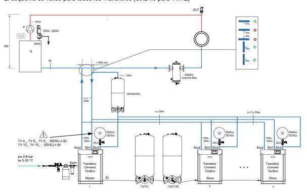
Zeparo Cyclone Max para la separación centralizada de lodos.
