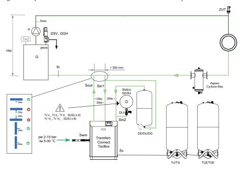
Zeparo Cyclone Max separador instalado como separador de lodos Zeparo ZUT purgadores de aire para salida y entrada de aire durante el llenado y vaciado Otros accesorios, productos y datos técnicos: Ficha de datos Pleno Connect, Zeparo y Accesorios
