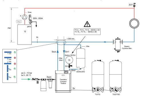
Para instalaciones de refrigeración con Transfero, rango de temperaturas de retorno 0°C < tr ≤ 5°C (puede requerir modificaciones en función de las normas locales)
