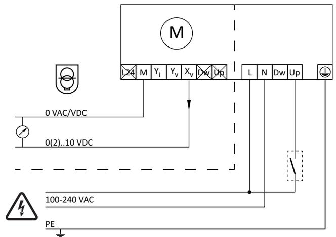
24 VAC/VDC-Betrieb nur mit Sicherheitstransformator nach EN 61558-2-6.
