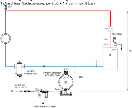
**Zeparo Cyclone Max** Schmutzabscheider mit Cyclone-Technologie und Magnet ZCXM im Rücklauf. **Zeparo ZUT** zur automatischen Entlüftung beim Füllen, Belüften beim Entleeren. **Weiteres Zubehör, Produkt- und Auswahldetails:** siehe Datenblätter Pleno, Zeparo und Zubehör.
