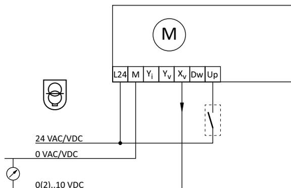
24 VAC/VDC darbojas tikai ar aizsargtransformatoru atbilstoši EN 61558-2-6
