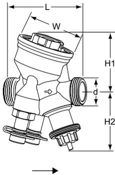
**DN 10-32 HP – 温度-20 – +120° C, ΔpV 最大600 kPa**
