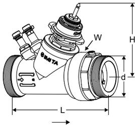
**DN 40-50 HP – 温度-10 – +90° C, ΔpV 最大600 kPa**
