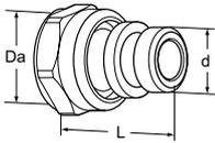
**带螺母和O型圈的直型套管
