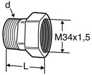
**不带阀芯管的散热器连接**
