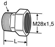
**不带阀芯管的散热器连接**
