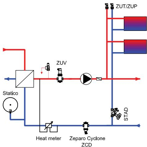
Zeparo Cyclone separator nečistoće može se ugraditi kako na povratu sekundara tako i direktno na toplinskom izvoru. Nema zahtijeva minimalnih udaljenosti prilikom ugradnje između npr. cijevnih lukova prije i poslije Zeparo Cyclone separatora.
