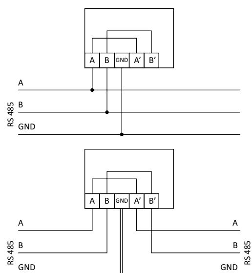
**Napomena:** A, B, A', B' i GND stezaljke izolirane su od ostalih stezaljki.
