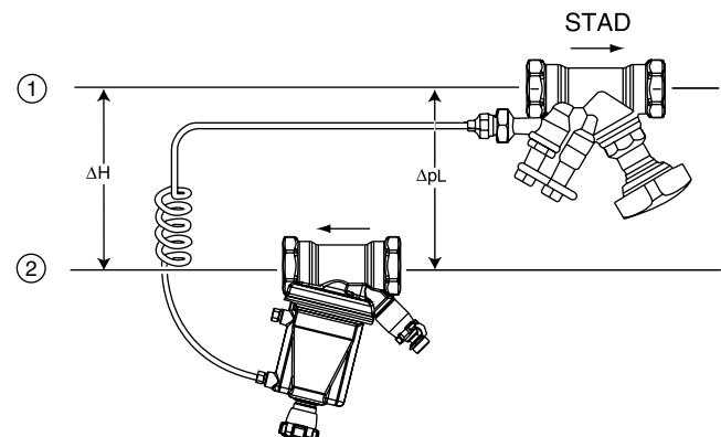
**Napomena!** STAP se mora montirati na povratnu cijev i sa ispravnim smjerom strujanja.
