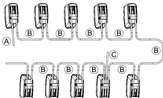
A: Kabel za povezivanje prvog TA-Slider 160/500 pogona s BACnet ili Modbus u linjsku vezu Bus komunikacije.
