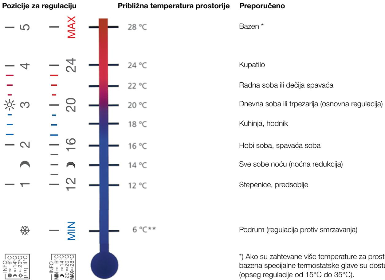
\*) Ako su zahtevane više temperature za prostor oko bazena specijalne termostatske glave su dostupne (opseg regulacije od 15°C do 35°C).
