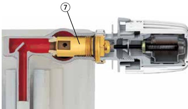
7. Termostatski uložak insert za radijatore sa integrisanim ventilom
