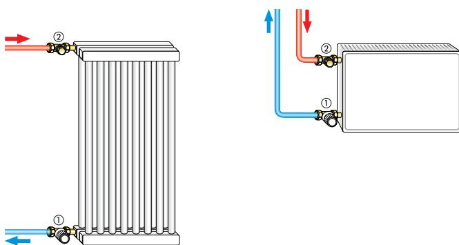
1. Telo termostatskog ventila za suprotni smer strujanja
