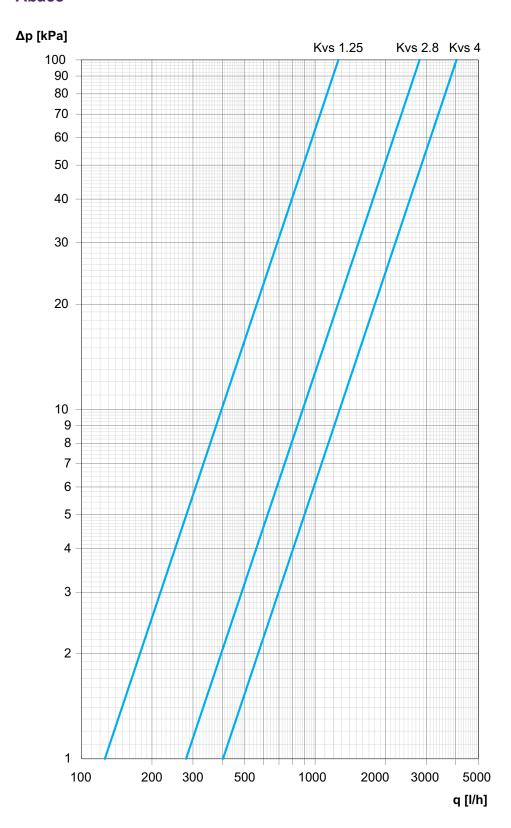
Kvs = Kv de ambas válvulas esfera totalmente abertas (lados A e B iguais)
