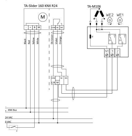
\*) A entrada binária pode ser usada para alternar entre o modo de aquecimento e resfriamento como uma alternativa para alternar pela comunicação KNX.
