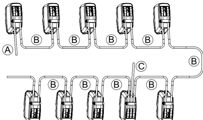
A: Para conectar no TA-Slider 160/500 BACnet ou Modbus vindo de um barramento.
