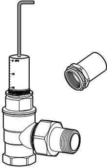
Use uma chave allen para ajustar a BPV à pressão diferencial requerida.
