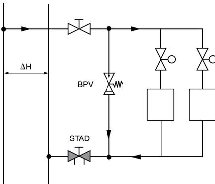
Em instalações com válvulas de radiador, em que muitas válvulas de radiador se fecharam, uma boa parte da cabeça da bomba vai afectar as válvulas, uma vez que a queda de pressão nas linhas e acessórios diminuiu. Se o diferencial de pressão disponível for superior a 30 kPa, podem ocorrer ruídos.
