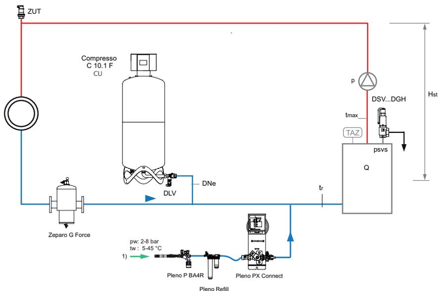
1) Priključak pripreme vode,  $p_w \geq p_0 + 1,7$  bar (max. 8 bar)
