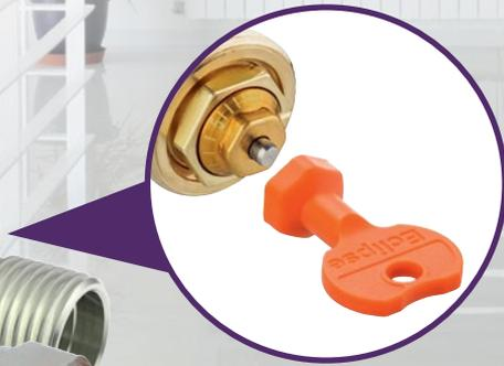
**Eclipse ist das kleinste Thermostat-Ventilunterteil mit automatischer Durchflussregelung und ist in allen Standard-Ventilgrößen und Bauformen erhältlich. Das Ventil regelt den Durchfluss unabhängig vom Differenzdruck auf den voreingestellten Wert. Dabei sind Durchflussbereiche von 10–150 bzw. 30 - 300 l/h möglich.**
