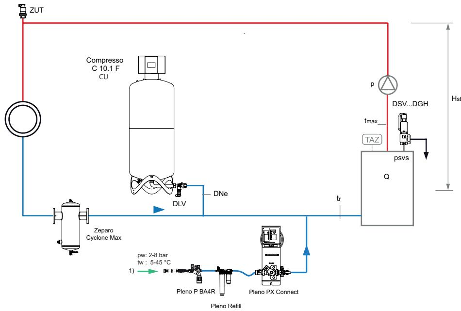
1) Prikluček za dopolnjevanje  $p_w \geq p_0 + 1,7$  bar, (max. 8 bar)
