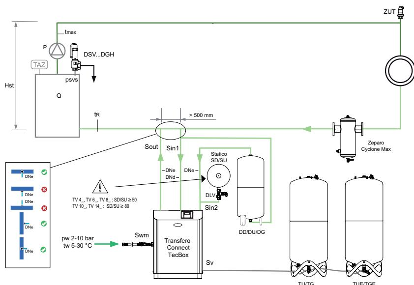
Zeparo Cyclone Max za centralno izločanje nečistoč.
