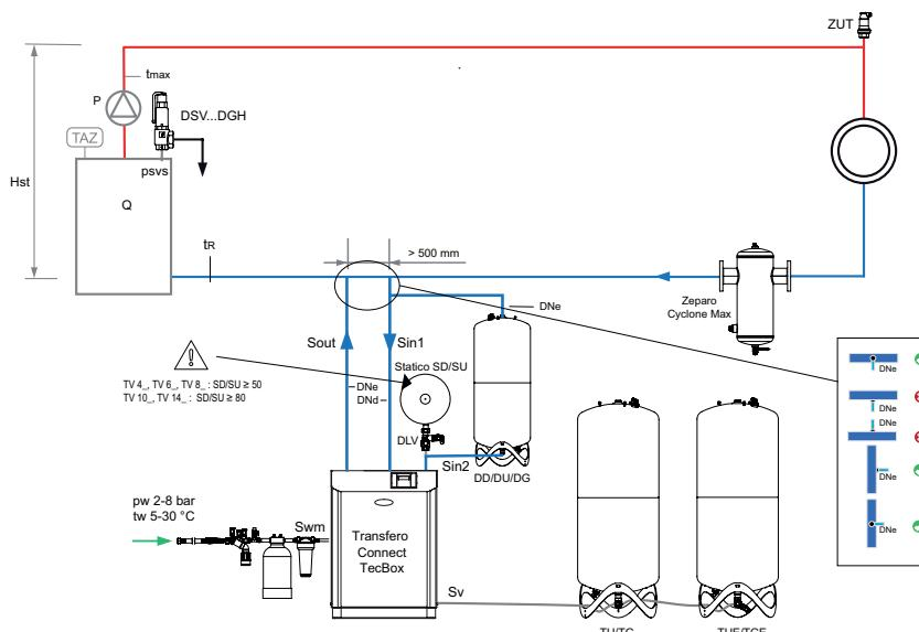
Zeparo Cyclone Max za centralno izločanje nečistoč.
