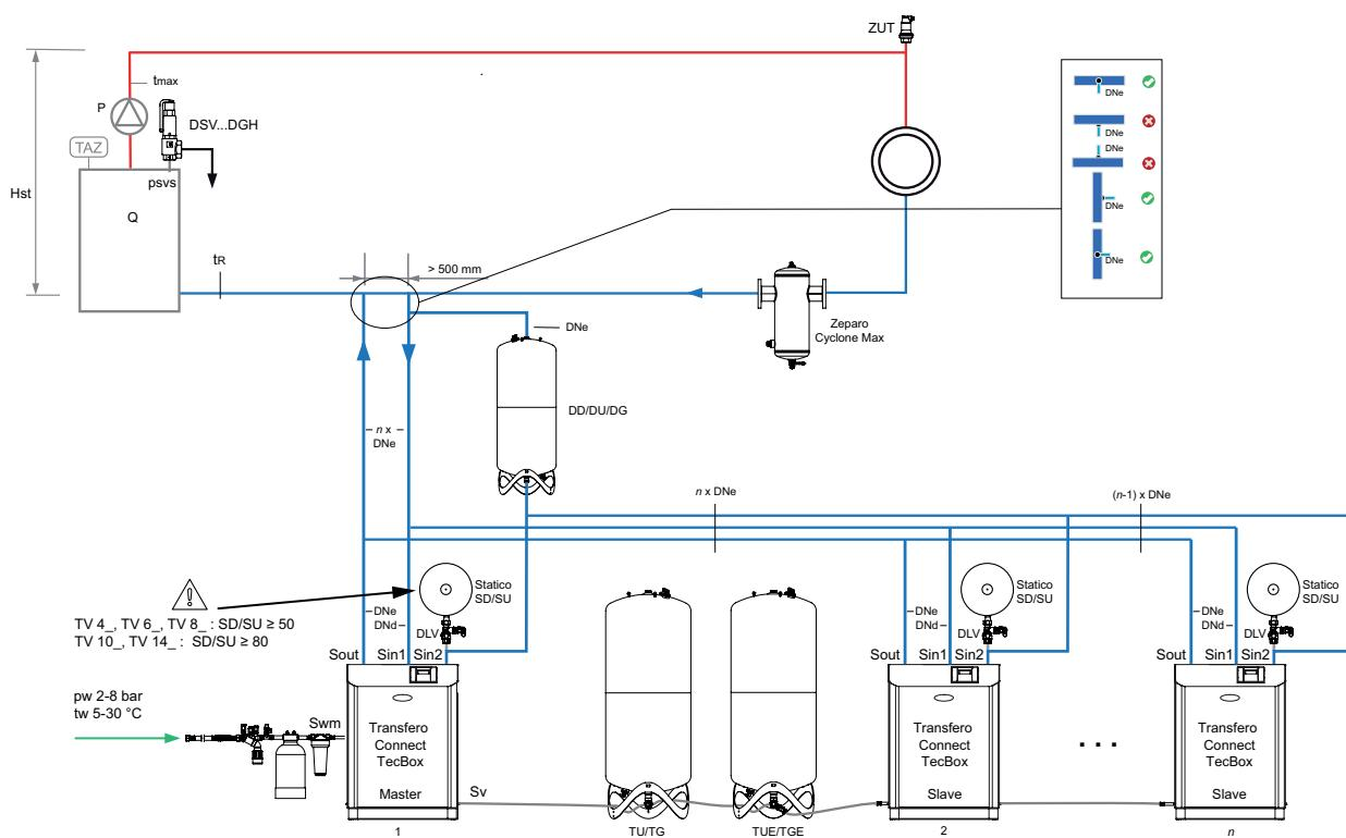
Zeparo Cyclone Max za centralno izločanje nečistoč.
