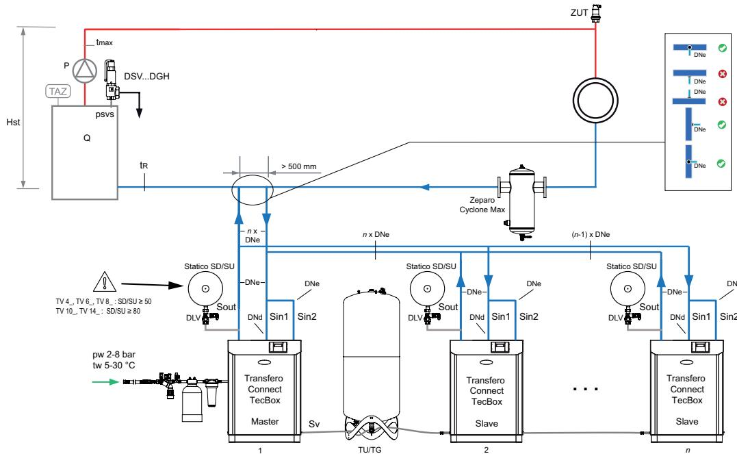
**Primer kombiniranega delovanja Master-Slave nadzora tlaka (PC/PCR) z dvema primarnima posodama in več TecBox-i v sistemu gretja, povratna temperatura  $70^\circ\text{C} < tr \leq 90^\circ\text{C}$**
