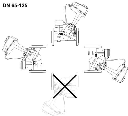
**Opomba:** Potreben je prostor nad pogonom/potopno pušo za temperaturni senzor za enostavno montažo / demontažo.
