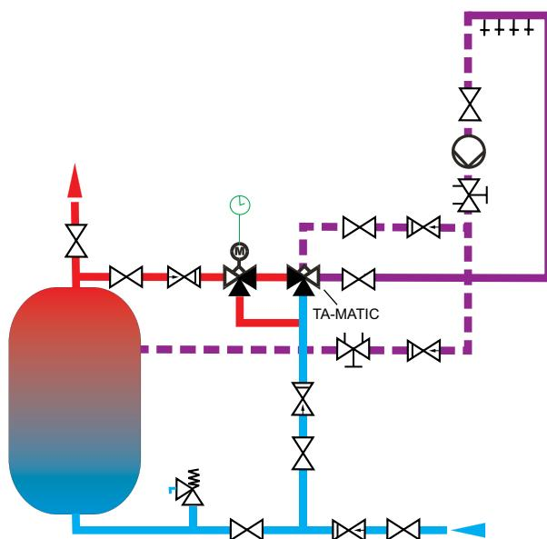
**Konstantna regulacija temperature povratka za generatorje toplote**
