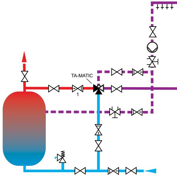
**Oskrba z mešano vodo s cirkulacijskim mešanjem in ločenim iztokom za toplo vodo. Možna je termična dezinfekcija z dodatnim tropotnim preusmerjevalnim ventilom.**
