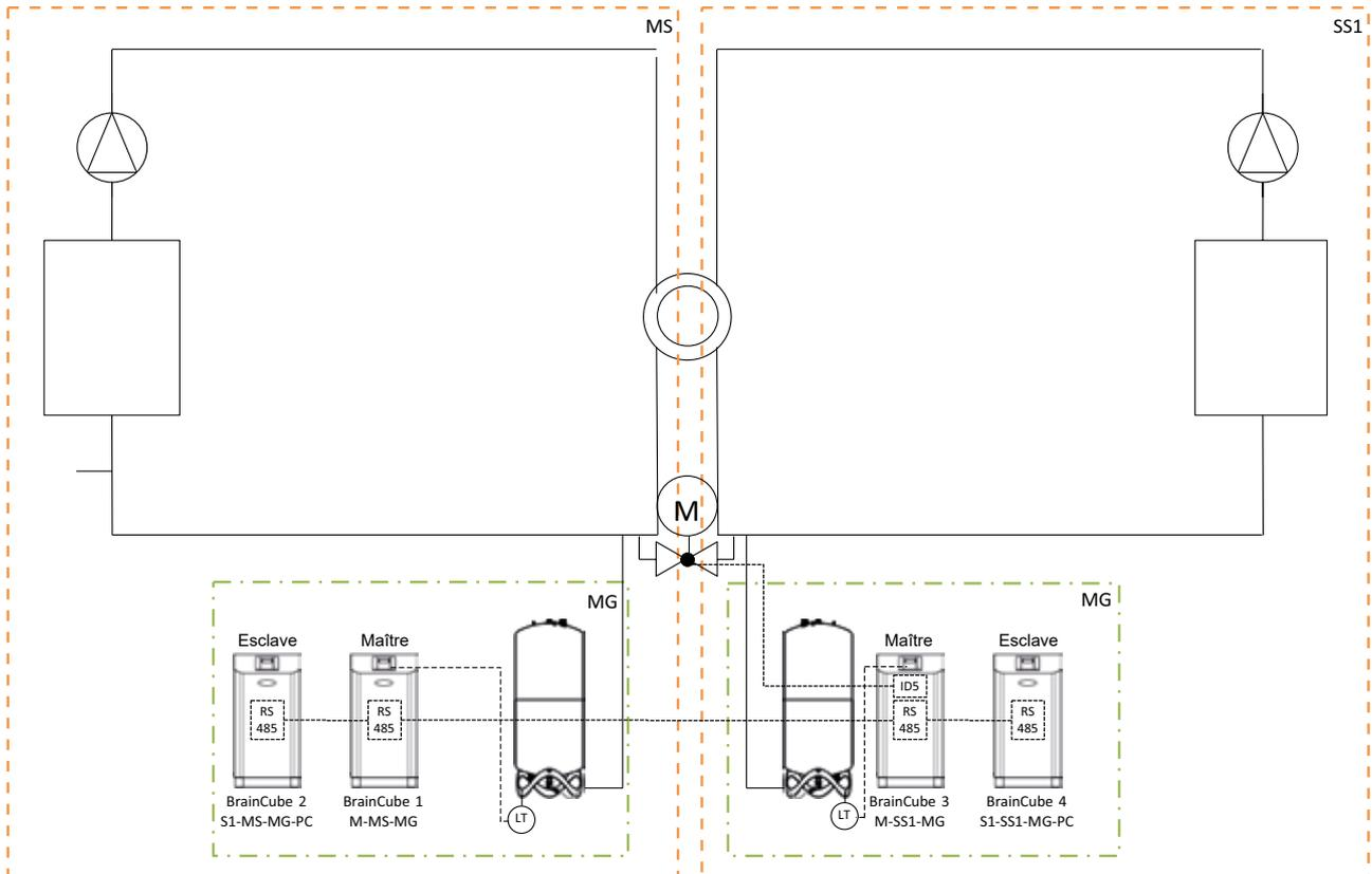
Schéma (Exemple circuit change-over MS-SS1 avec vanne motorisée entre les vases d'expansion Transfero)
