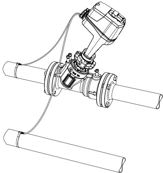
**TA-Modulator s pohonem v provedení 2T a vyvažovacím ventilem STAF**
