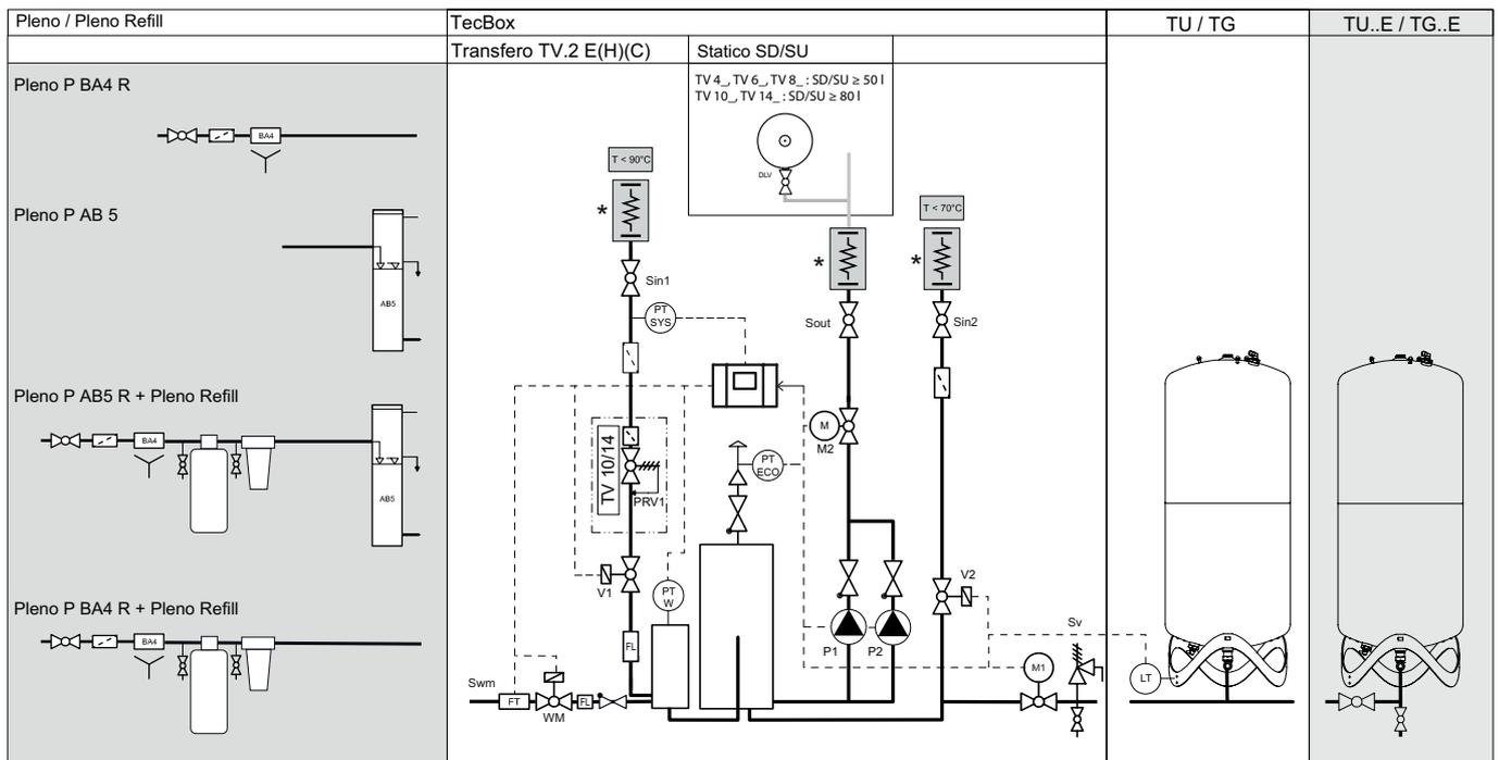
\* При соединении с жесткими трубопроводами важно убедиться в отсутствии осевого, вертикального или горизонтального напряжения. Соединения не должны подвергаться никаким дополнительным нагрузкам. Там, где указано, следует соблюдать максимальные моменты затяжки. Если моменты затяжки не указаны, необходимо соблюдать уровень техники для соответствующего подключения. Гибкое соединение предпочтительнее жесткого.
