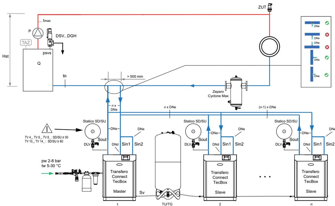
**Пример комбинированной работы с контролем давления Первичный-Вторичный бак (PC/PCR) с двумя первичными баками и несколькими ТесВох в системах отопления, температура обратки  $tr \leq 70^\circ\text{C} < tr \leq 90^\circ\text{C}$**
