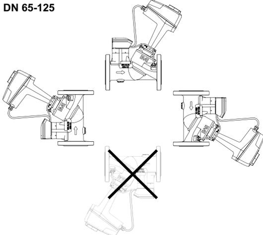
**Remarque :** Prévoir un dégagement suffisant au-dessus du moteur/doigt de gant pour la sonde de température afin de permettre son installation ou démontage.
