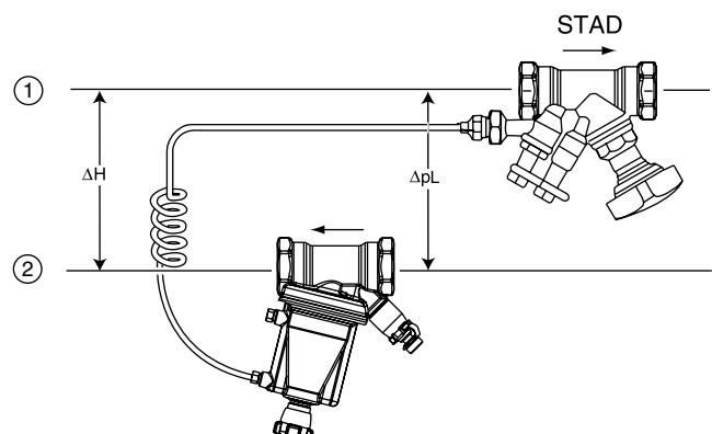
**Внимание!** STAP должен быть установлен на обратный трубопровод с соблюдением направления потока.
