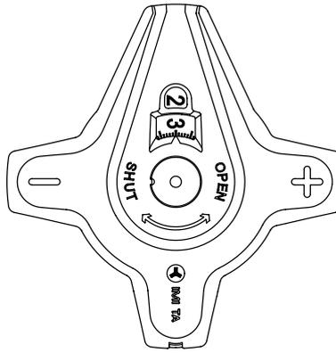
Рис. 2b Настройка 2.3 вид сбоку
