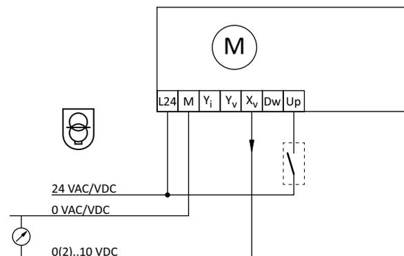
24 VAC/VDC работает только с защитным трансформатором в соответствии с EN 61558-2-6
