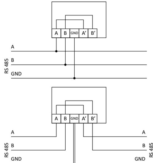
**Примечание:** Клеммы A, B, A', B' и GND («Земля») изолированы от всех остальных клемм.
