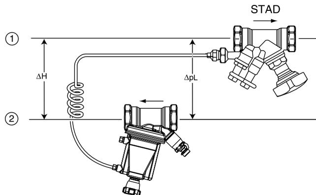
**注意!** STAD必须安装在回水管上，并按正确的水流方向设置。为便于在狭小空间内安装，可将阀帽拆除。
