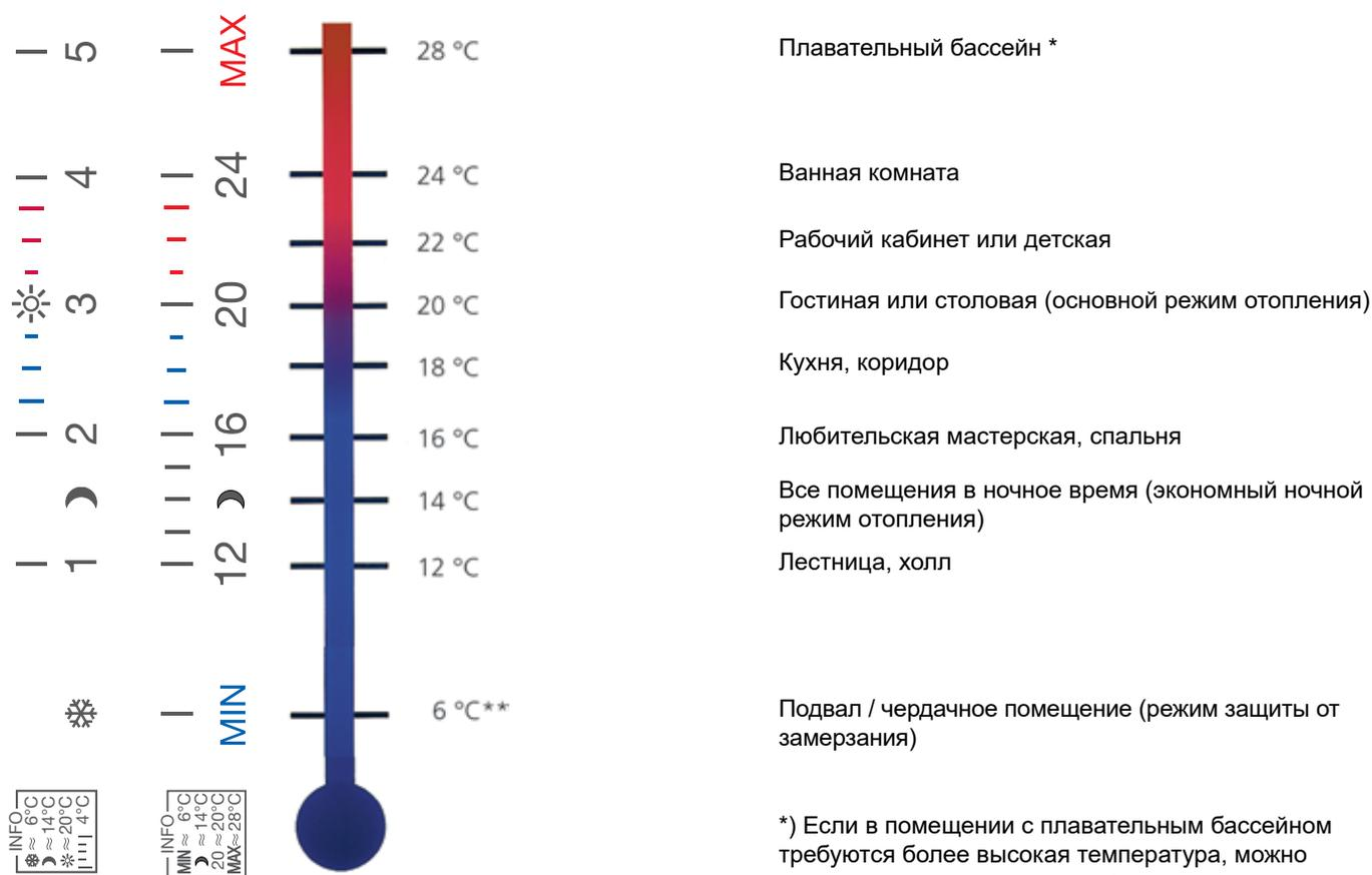
\*) Если в помещении с плавательным бассейном требуются более высокая температура, можно воспользоваться специальной моделью термостатической головки (диапазон настройки температуры от 15°C до 35°C).
