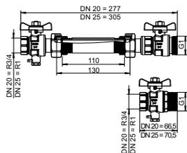
**Kit di collegamento con valvole a sfera, attacco diretto, comprensivo di distanziale per contatore di calore in ritorno. Valvole a sfera con attacco M10x1 per misurazione diretta in mandata e ritorno.**
