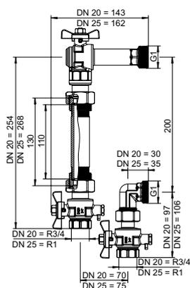
**Kit di collegamento con valvole a sfera, attacco ad angolo, comprensivo di distanziale per contatore di calore sul ritorno. Valvole a sfera con attacco M10x1 per misurazione diretta in mandata e ritorno.**
