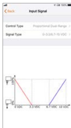
Signal d'entrée ou double gamme signal d'entrée pour la commutation chauffage/refroidissement
