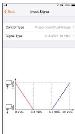
Dual-range ingangssignaal voor omschakeling verwarmen-koelen
