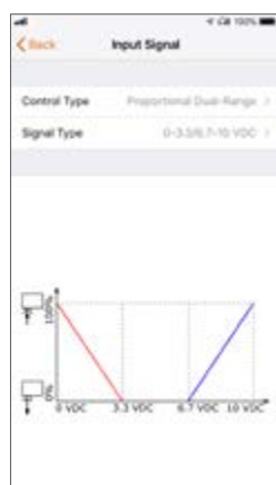
Signal d'entrée ou double gamme signal d'entrée pour la commutation chauffage/refroidissement
