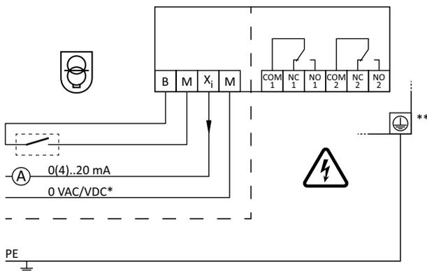
\*) Masseanschluss Niederspannung.
