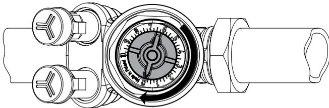
1. Drehen Sie das Handrad im Uhrzeigersinn auf die Stellung 0.
