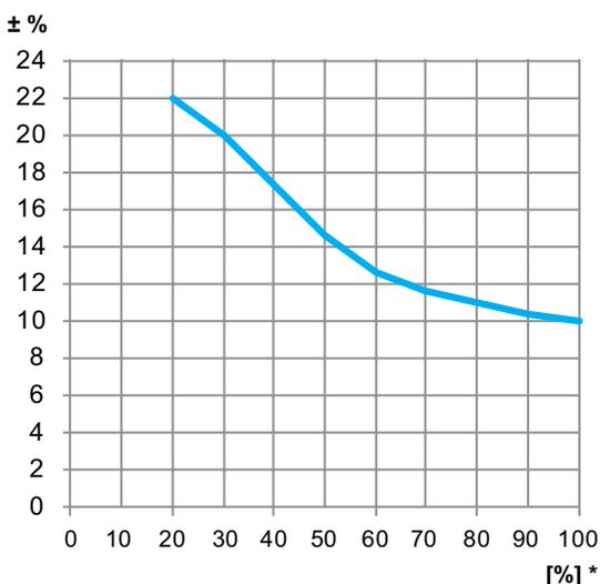
\*) Voreinstellung in % des komplett geöffneten Ventils.
