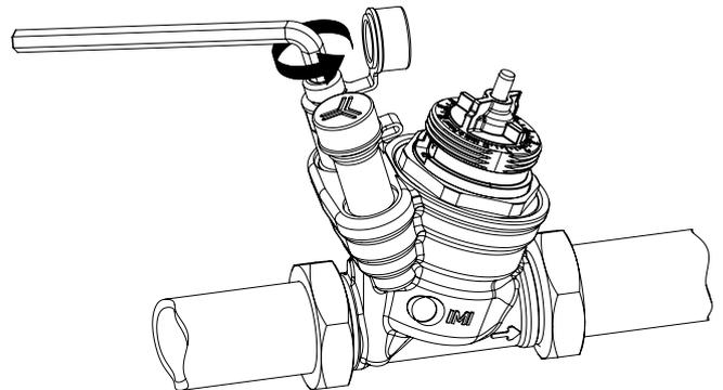
1. Entfernen Sie den Antrieb.
