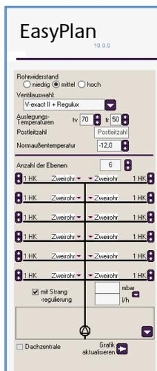
Zum Zeichnen des Strangschemas geben Sie im Dialogfenster die „Anzahl der Ebenen“ und die Anzahl der Heizkörper am Strang ein (die Programmgrenzen sind maximal 6 Ebenen, sowie maximal 12 Heizkörper nach links und rechts
