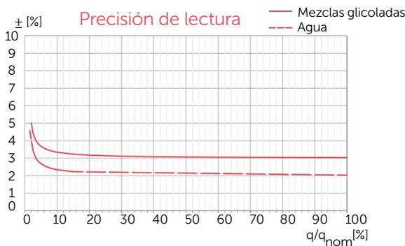
La precisión de la medida está acotada entre las siguientes condiciones del caudal circulante:
